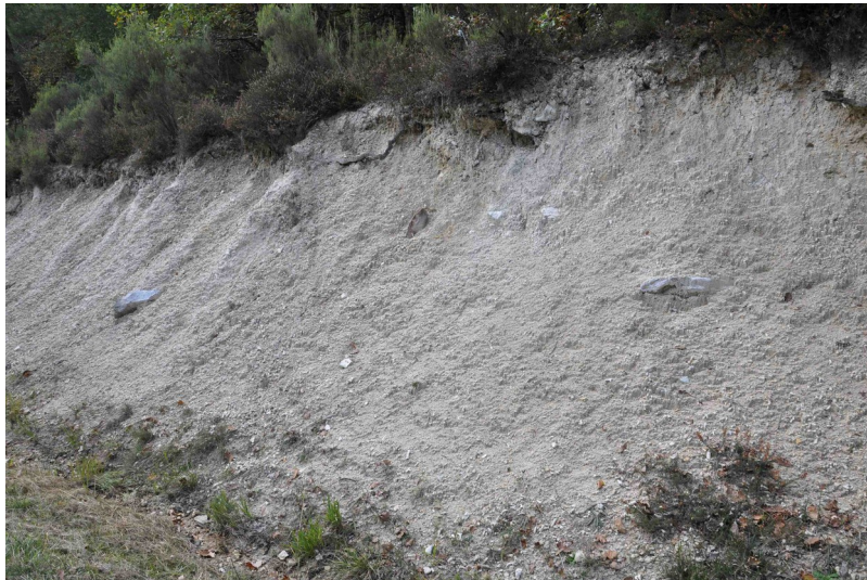
Fig. 2.2 - Aspect du matériau argilo-siliceux spongolithique blanchâtre à dalles de silex du tuffeau jaune soliflué (CC4-6S-C3c).
