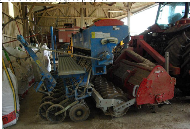
Semoir sur mesure permettant de semer sans labour préalable.
